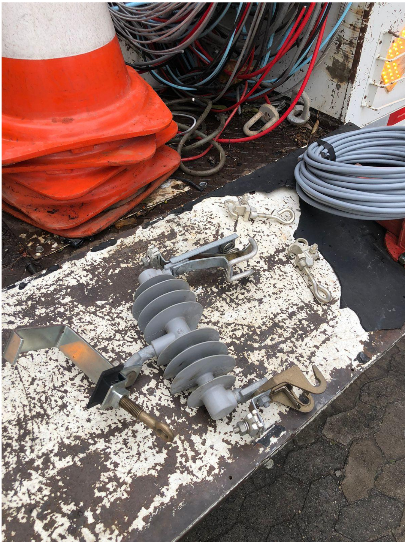
Figura 11 - Base fusível adaptada ao suporte
